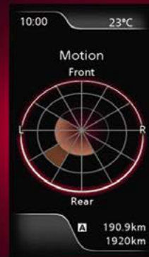
Rückwirkende Verlaufsanzeige der Fliehkräfte
