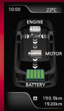
Anzeigestatus für Motorunterstützung und Energiefluss (nur Fahrzeuge mit SHVS)
