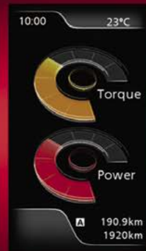
Echtzeitanzeige von Leistung und Drehmoment
