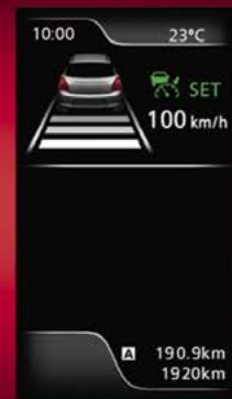
Anzeige der für die Abstandsregelung eingestellten Geschwindigkeit und des gewählten Fahrzeugabstands
