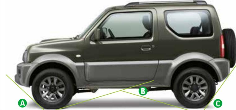
**A** 34° Böschungswinkel vorne      **B** 31° Rampenwinkel      **C** 46° Böschungswinkel hinten
